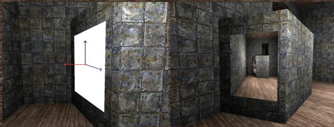
A multiplicação do vetor diretor (preto) com a normal da parede (vermelha) sempre resultará em um vetor cônico um posicionamento confiável. "horizontal" (azul) que pode ser usado para desenharmos o portal.
