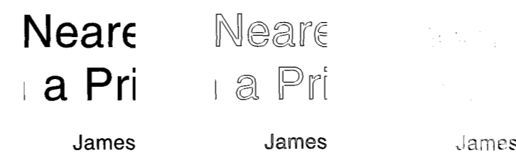
Figura 3: Exemplo de aplicação de operador automaticamente gerado para identificação de títulos. Da esquerda para a direita: imagem original, aplicação de operador com janela esparsa 5x5 e 7x7.
