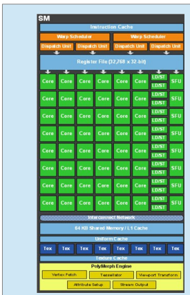
Representação de uma unidade de processamento da GTX 460 SE.
